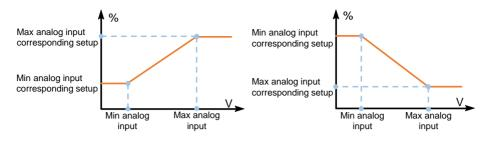
Fig.5-19 Analog input linear curve
